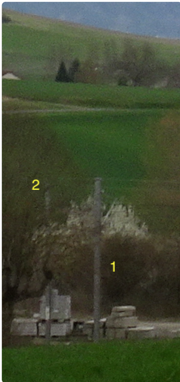
图 4.13: 在景观中选择附近参考点，以便从观察点精确对齐视线 (1: 前景最近的电线杆; 2: 铁路另一侧的电线杆)。
