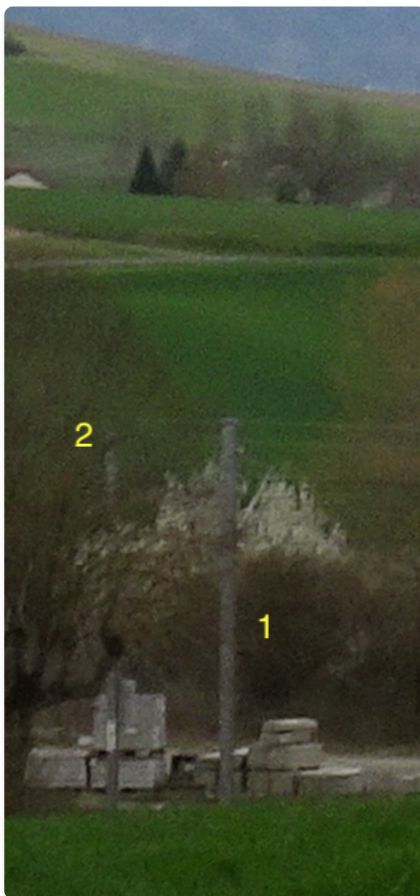
Рис. 4.13: выбор ближайших ориентиров на местности для точного совмещения линии визирования с точки наблюдения (1: ближайший столб на переднем плане; 2: столб с другой стороны железной дороги).
