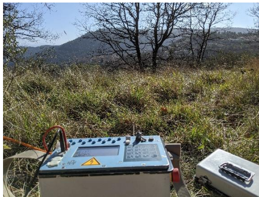
Illustration 101 : Photo du résistivimètre lors de l'acquisition le long de PE2.
