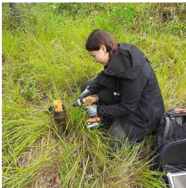
Illustration 54 : Photographie de l'instrumentation du piézomètre "FPey".
