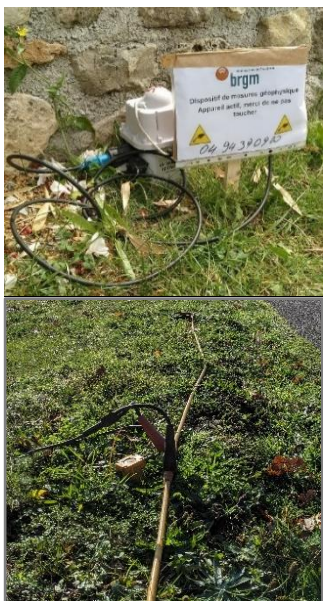
À gauche : photos d'un récepteur sans fil utilisé pour l'imagerie sismique 3-D (haut) et d'un géophone relié au câble de mesure (bas, profil 2-d sismique réfraction). À droite : Photo de la source sismique de type chute de poids accélérée A200P.
